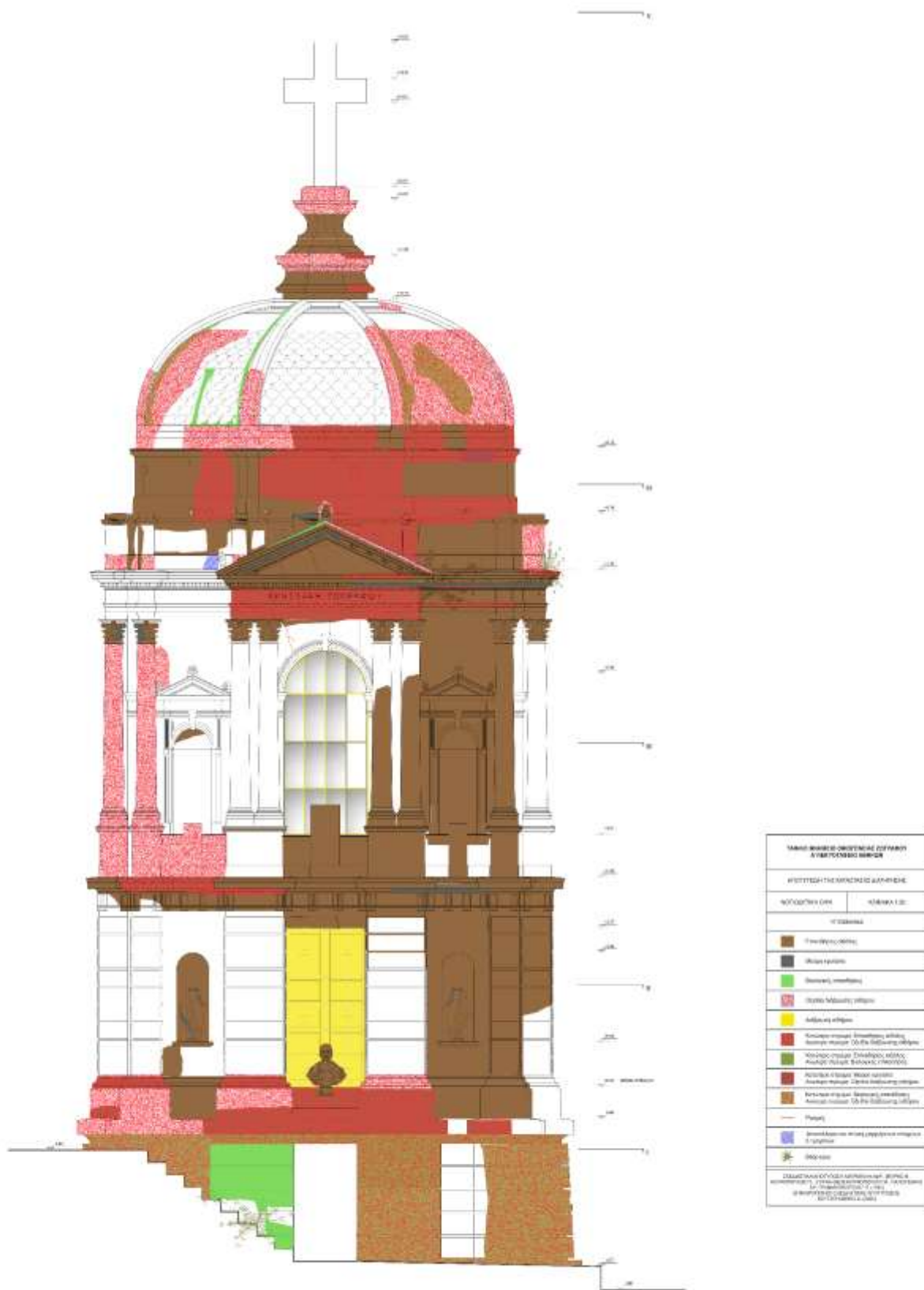
Αποτύπωση των αλλοιώσεων στο Μνημείο
